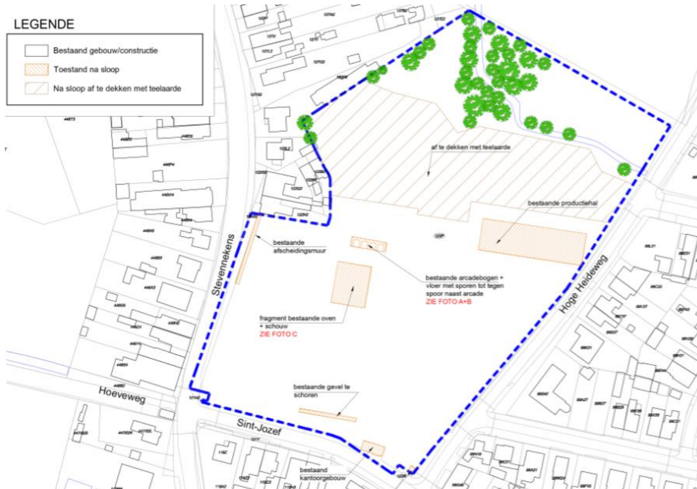
Figuur 1: toestand na uitvoering sloopwerken
